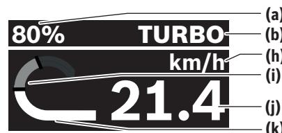
(a) Stav nabítí akumulátoru eBike (lze nakonfigurovat)
