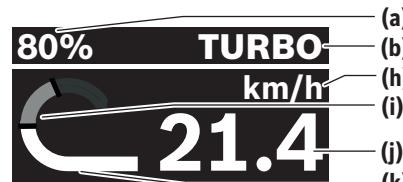
**(a)** Nivelul de încărcare a acumulatorului eBike (configurabil)
