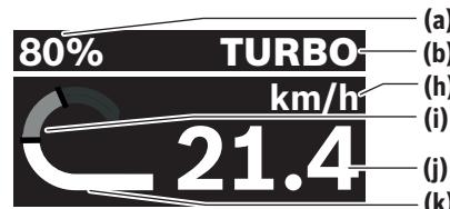
(a) eBike-akkumulátor töltöttségi állapota (konfigurálha-
